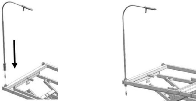
Infilare il tubo di sostegno della lampada da lettura (con adattatore e cavo di collegamento) dall'alto nella bussola di supporto del raddrizzatore (sinistra o destra) e fissarlo.
